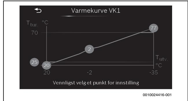
Fig. 6 Varmekurve standardvisning
